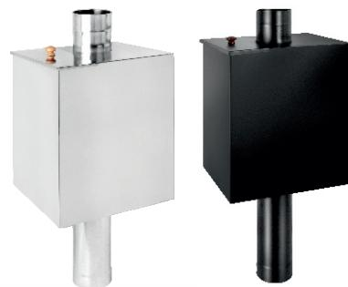
Нагрев жидкости происходит за счет тепла уходящих в трубу дымовых газов. Экономит пространство в бане и выполняет функцию защитного кожуха, препятствующего инфракрасному излучению. Сверху бак оснащен крышкой, снизу имеется штуцер G3/4 дюйма.
